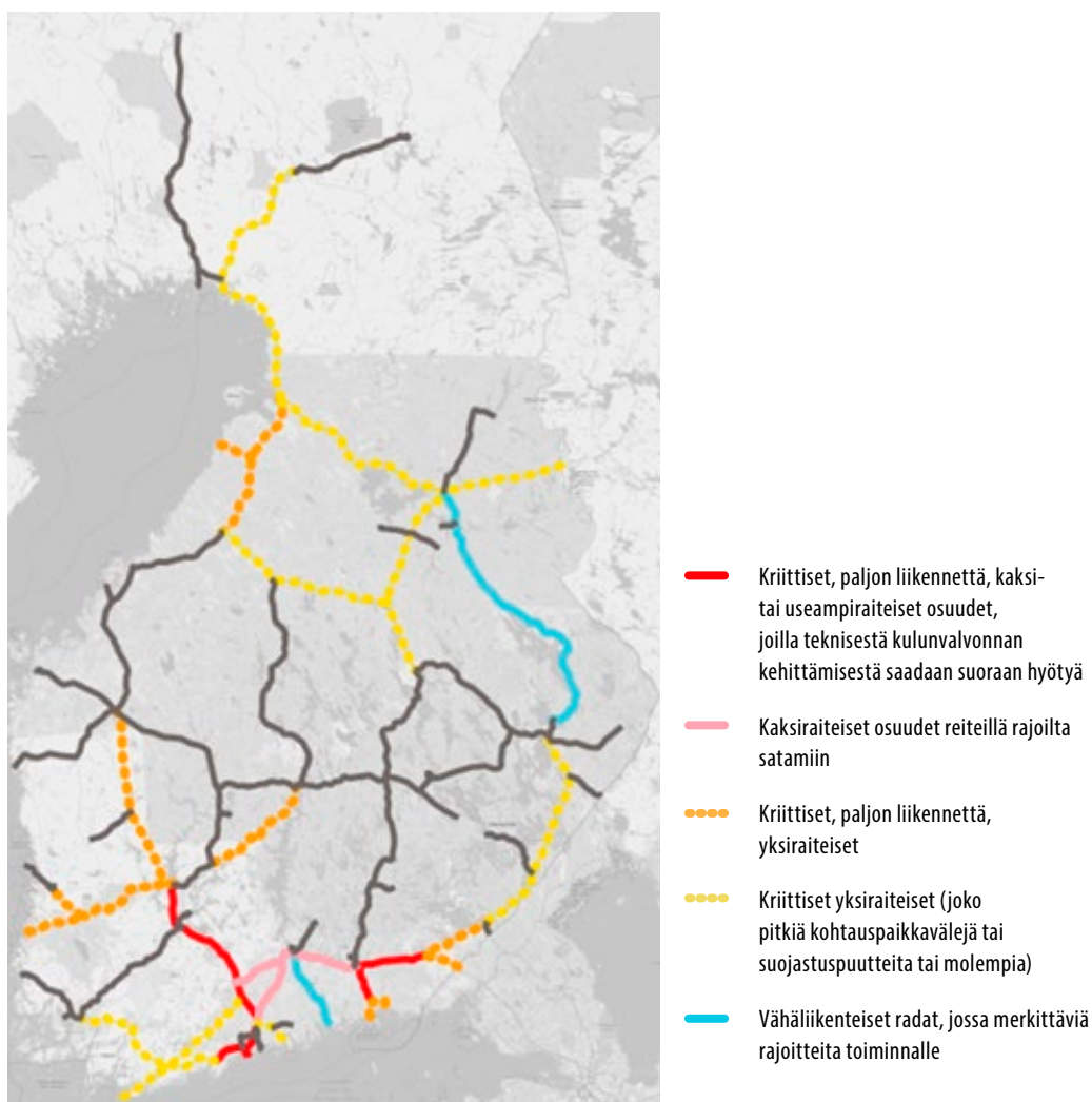
Kuvio 17. Suomen rataverkko, joka varustetaan modernilla radiopohjaisella ETCS-järjestelmällä. Modernilla järjestelmällä voidaan vaikuttaa tehokkaimmin kuvassa näkyviin koko Suomen ratakapasiteetin pullonkauluihin.
